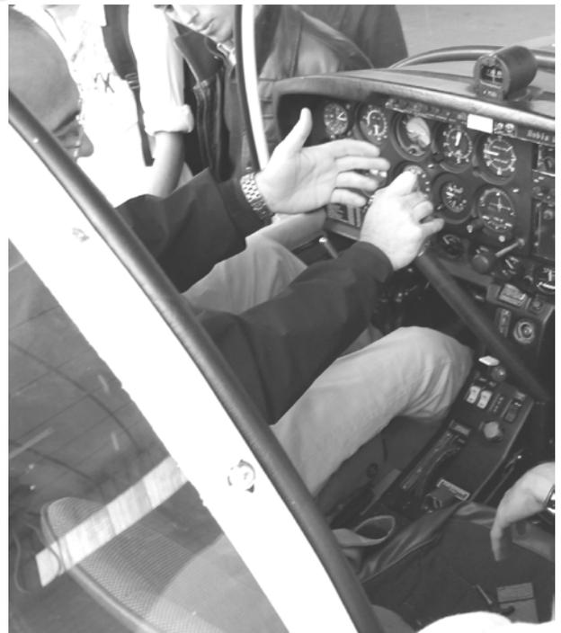
*Pilote paraplégique utilisant le système de malonnier*
