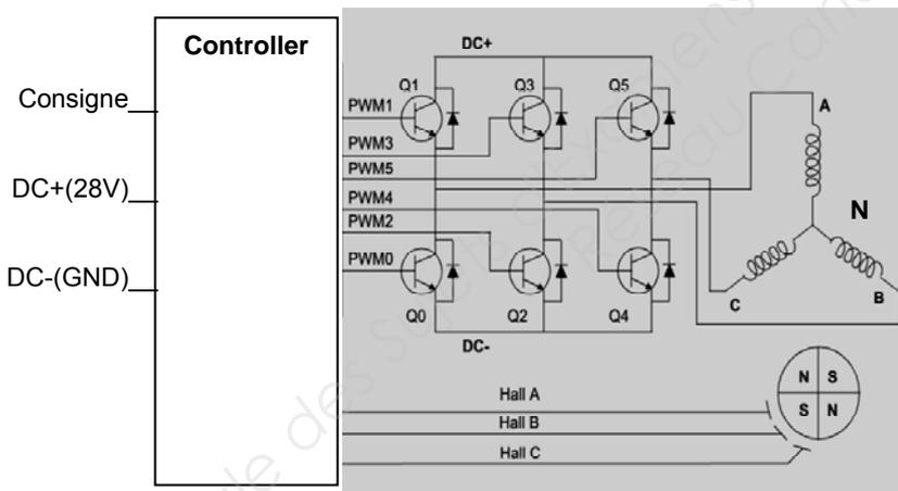
Le contrôleur est un calculateur qui pilote les différentes bobines du moteur en fonction de la consigne et du retour d'informations de position du rotor.
